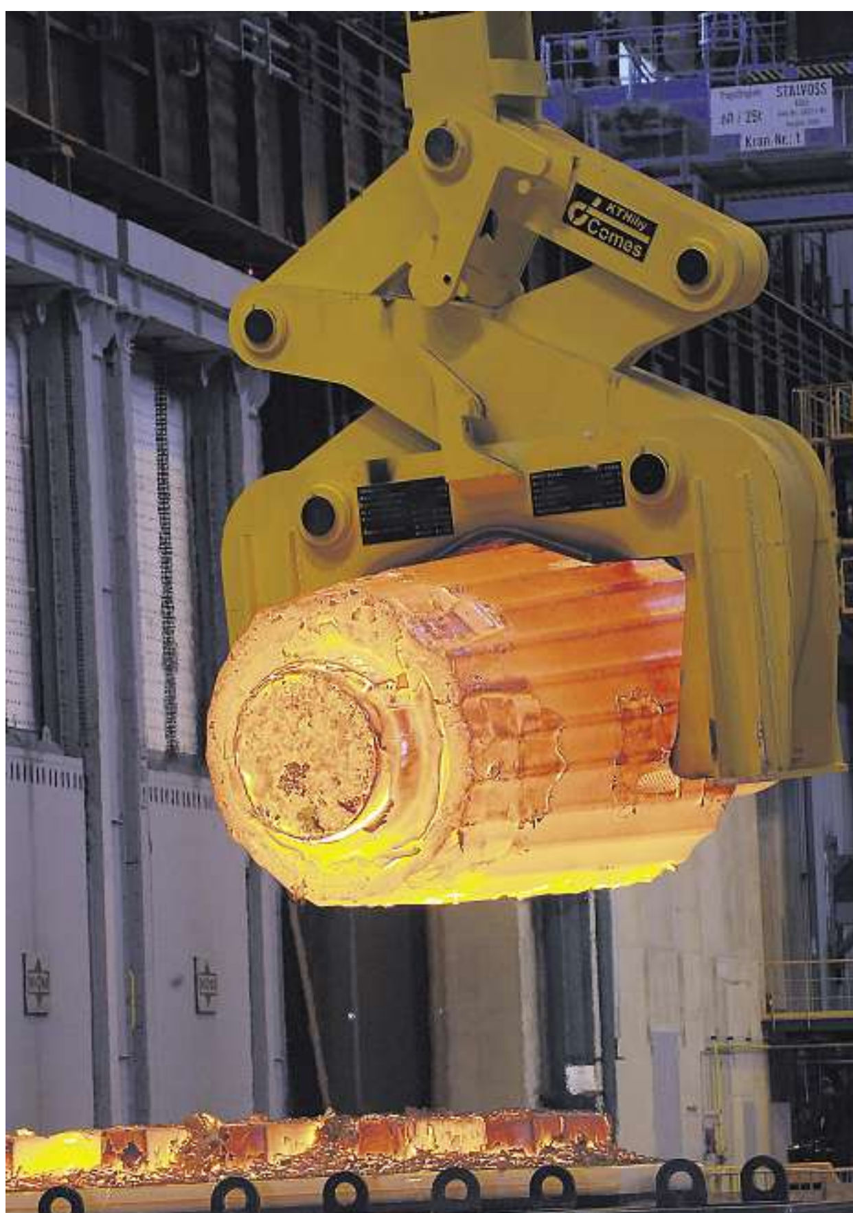
Stahl, 1.050 Grad heiß, wird durch die Halle hin zur Presse getragen
