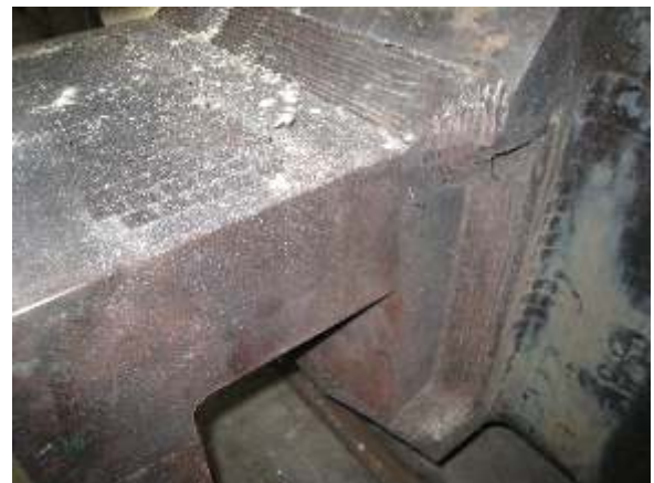
Angeschweißtes Kupplungsstück aus 25CrMo4
