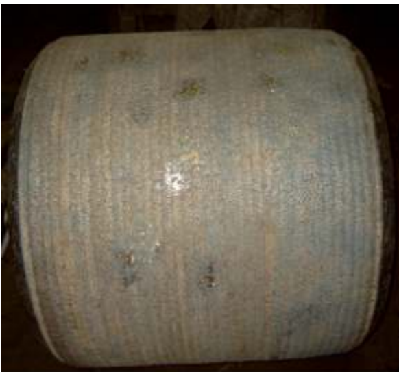
Walzenkörper Werkstoff 18 NiCrMo 14 6 Hartauftragsschweißung 56 - 58 HRC
