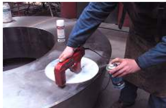
MT - Prüfung eines Stanzringes
