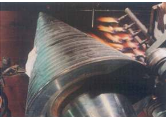
Axialwalze für Ringwalzwerk Werkstoff 56 Ni Cr Mo V
