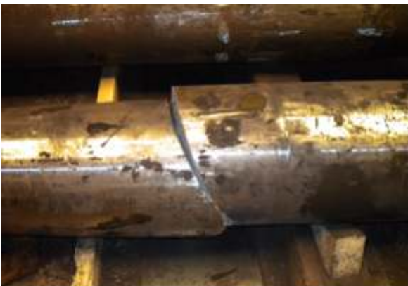
Gebrochene Welle Durchmesser 450 mm
