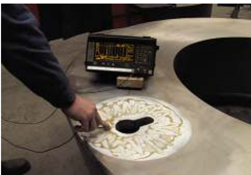
UT - Prüfung eines Stanzringes
