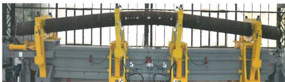
3 Gebogenes Rohr: Beulenbildung im Prüfabschnitt
