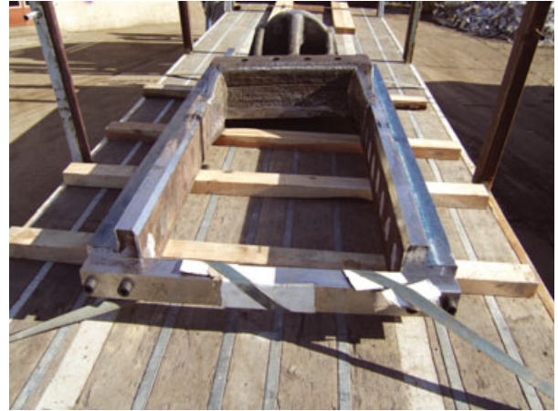
Messerschlitten nach der Überholung
