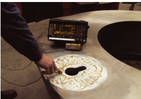
UT - Prüfung eines Stanzringes
