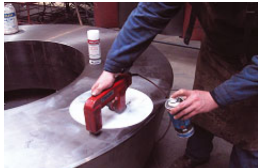
MT - Prüfung eines Stanzringes
