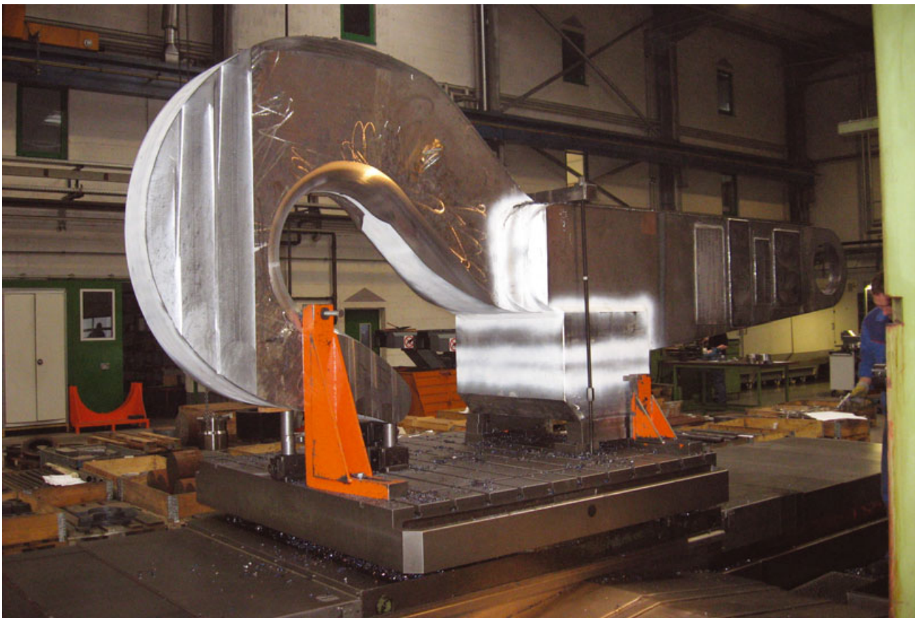
Spanende Bearbeitung eines 200t Zwischenhakens
