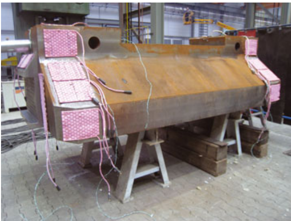
Anbringen der Heizmatten
