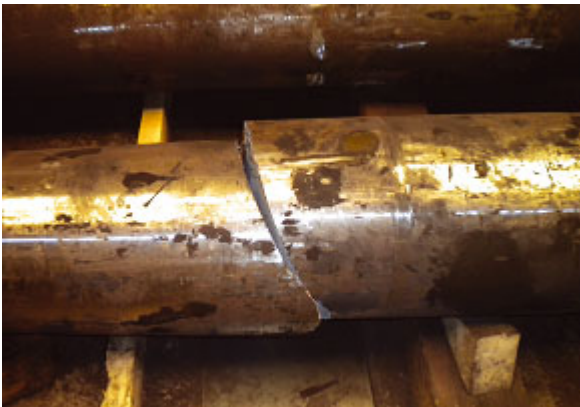
Gebrochene Welle Durchmesser 450 mm
