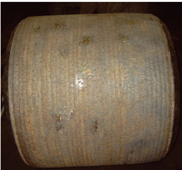
Walzenkörper Werkstoff 18 NiCrMo 14 6 Hartauftragsschweißung 56 - 58 HRc
