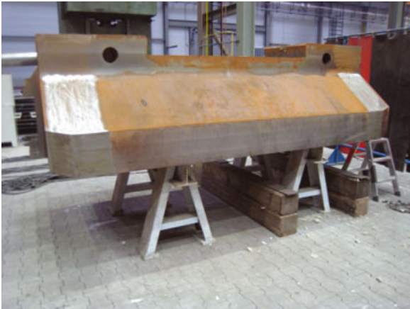
Werkstück vor der Schweißung GS 25 CRNiMo 4
