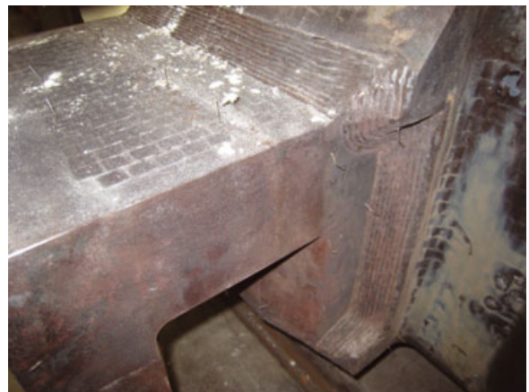
Angeschweißtes Kupplungsstück aus 25CrMo4
